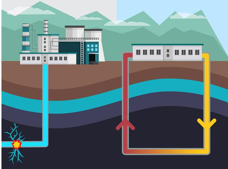
Fracking-ul (fracturarea hidraulică) este o metodă utilizată pentru a extrage petrol sau gaze naturale prin injectarea apei la presiune înaltă.
